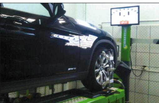
Geometria 3D: sensores são posicionados nas rodas
